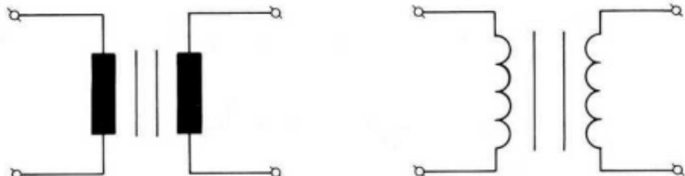
Bild 207a Transformator mit Eisenkern
