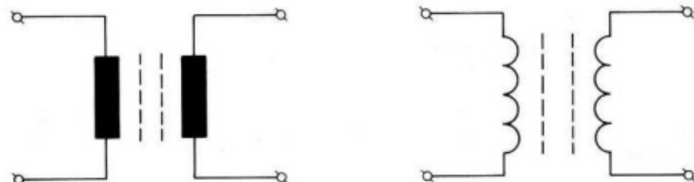
Bild 207b Transformator mit Ferritkern
